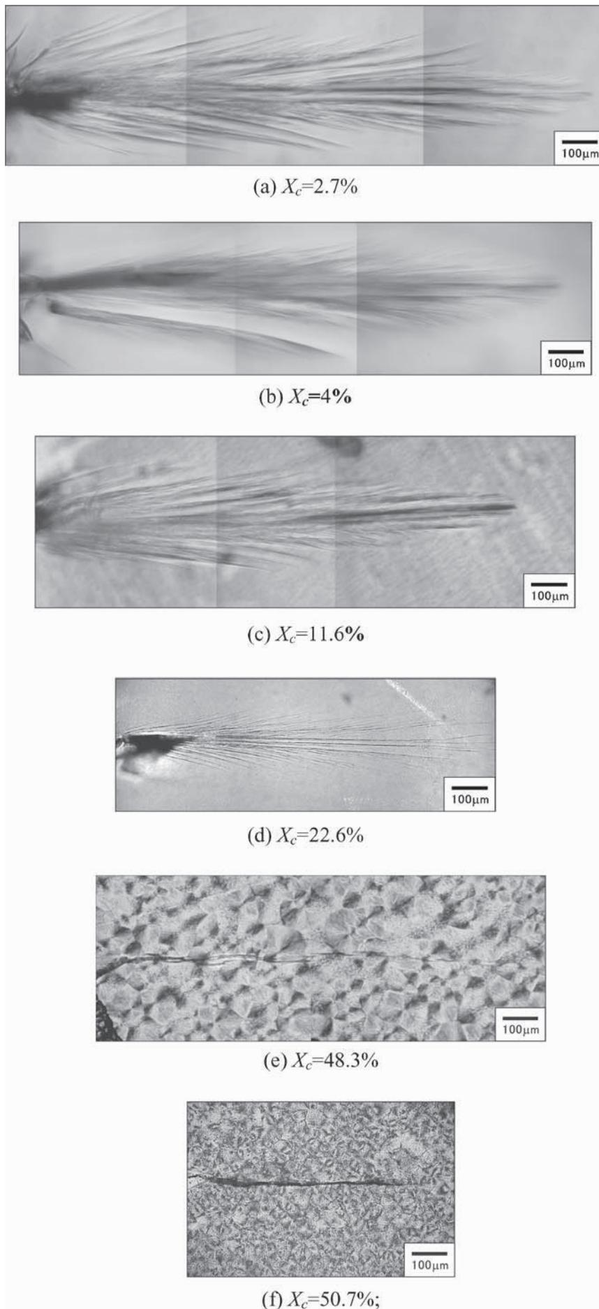
Figure 3 Polarizing microphotographs of crack behaviors of PLA. (a)  $X_c = 2.7\%$ ; (b)  $X_c = 4\%$ ; (c)  $X_c = 11.6\%$ ; (d)  $X_c = 22.6\%$ ; (e)  $X_c = 48.3\%$ ; (f)  $X_c = 50.7\%$ ; (g)  $X_c = 55.8\%$ .
